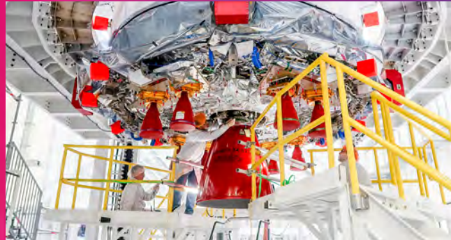
Teknisyenler, Artemis II görevinde Ay'ın etrafında astronotları taşıyan Orion uzay aracına güç ve itme sağlamaya yardımcı olacak Avrupa Servis Modülü üzerinde çalışıyor.
